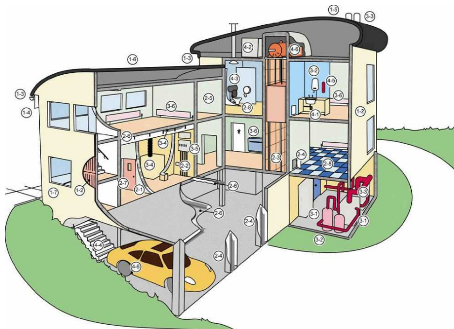
Rysunek nr 1 - Schemat przedstawiający typowe lokalizacje materiałów zawierających azbest w budynkach, instalacjach, urządzeniach
