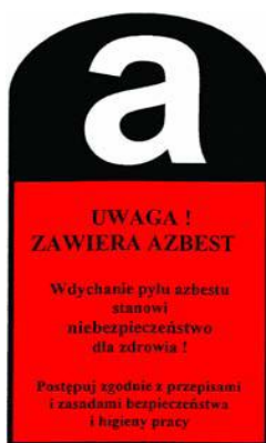
Rys. 2 – Oznaczniki stosowane w miejscach potencjalnej emisji azbestu.
