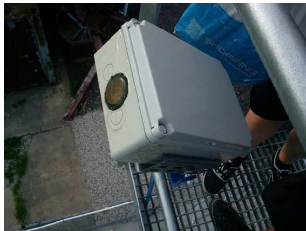
Ryc. 9. Skrzynka z woreczkami chłonicymi wilgoć oraz detektor w skrzynce (fot. J. Furmankiewicz).
