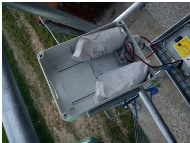
Ryc. 9. Skrzynka z woreczkami chłonicymi wilgoć oraz detektor w skrzynce (fot. J. Furmankiewicz).
